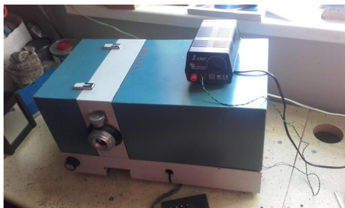
3.attēls. Monohromatora LOMO DR-12 automatizācija
